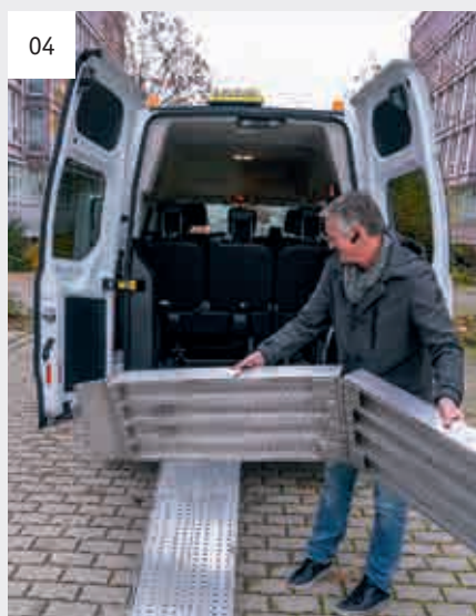
Aufbau der zweiten faltbaren Rollstuhlrampe
