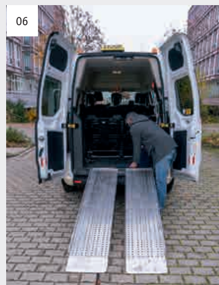
Überprüfung und Fixierung beider Rollstuhlrampen
