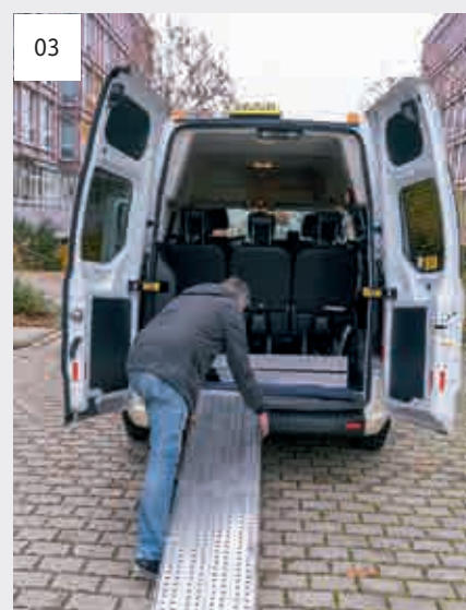
Platzierung der ersten Rollstuhlrampe
