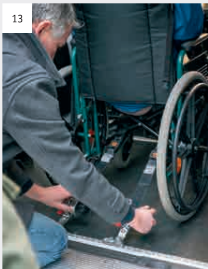
Überprüfung der beiden Sicherungen
