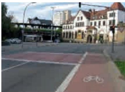
Aus einem Radfahrstreifen, Schutzstreifen oder Radweg hervorgehender, sich über eine volle Fahrstreifenbreite erstreckender Aufstellbereich für Radfahrer an signalisierten Knotenpunkten.
