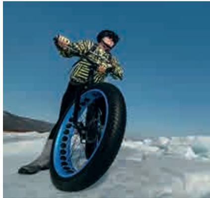
Fatbikes ähneln Mountainbikes und sind für Untergründe wie Sand und Schnee ausgelegt. Sie haben extra breite Reifen von 4.0" bis 4.8", die Durchmesser von ca. 30" erreichen. Dadurch sind auch überbreite Felgen (65 bis 100 mm) mit einem Durchmesser von 26" notwendig. Aufgrund der besonders großen Laufräder werden beim Rahmen oft 29"-ähnliche Geometrien und geänderte Gabeln, Kurbeln und Naben eingesetzt.
