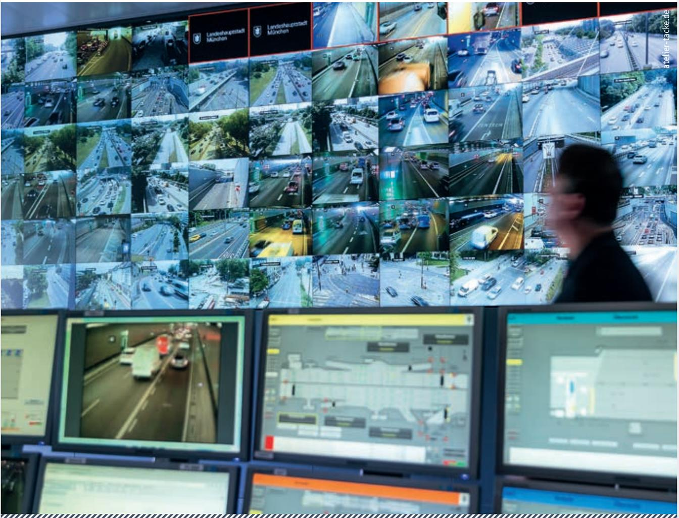
Detektionssystem zählfließenden Verkehr, Stau, Pannestreifenbelegung, Fußgänger, Geisterfahrer und Rauch erkennt.
