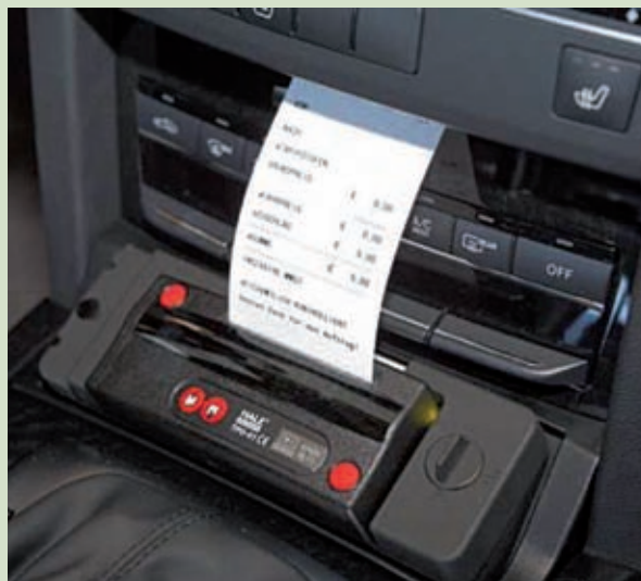
Integrierter Einbauhalter TPD-01 für Mercedes-Benz E-Klasse Baureihe 212
