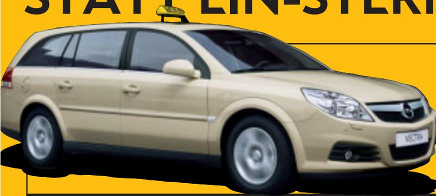
Der OPEL Vectra Caravan Edition 1,9DTI ECOTEC Turbodiesel-Motor; 110 kW (150 PS)\*\*
